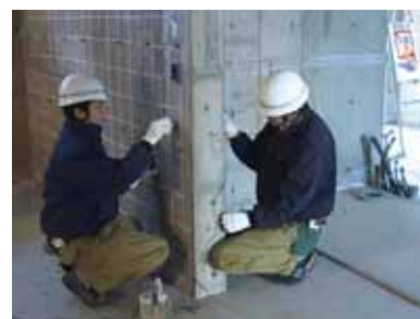
写真 2 透過法による音速測定
