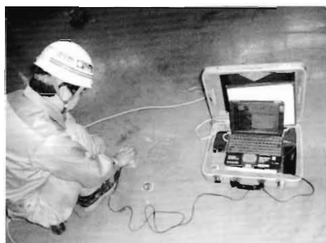
写真3 測定状況（1探触子法）
